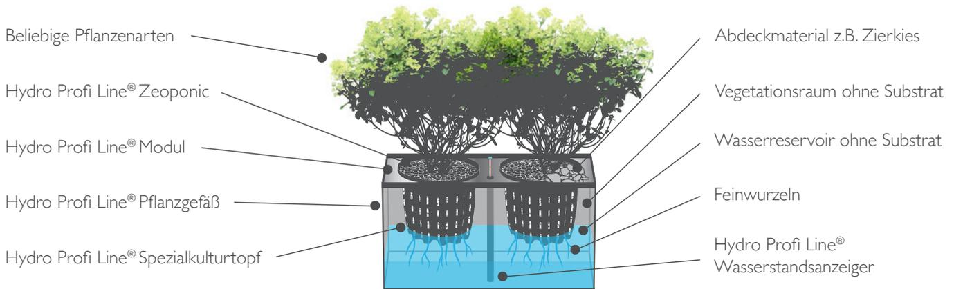
Im Hydro Profi Line® System werden Pflanzen in Spezialkulturtopfen in ein Modul gehängt und hängen somit in einer einzigartigen Wurzelvegetationskammer.
