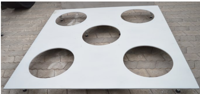
Schwerlastbodenplatte mit verstellbaren Füßen zur Niveauregulierung
