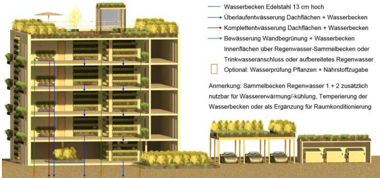
HPL® Gebäudebegrünungssysteme - Wasserversorgung der Innenraumbegrünungen (Detailbeschreibung siehe Seite 6)
