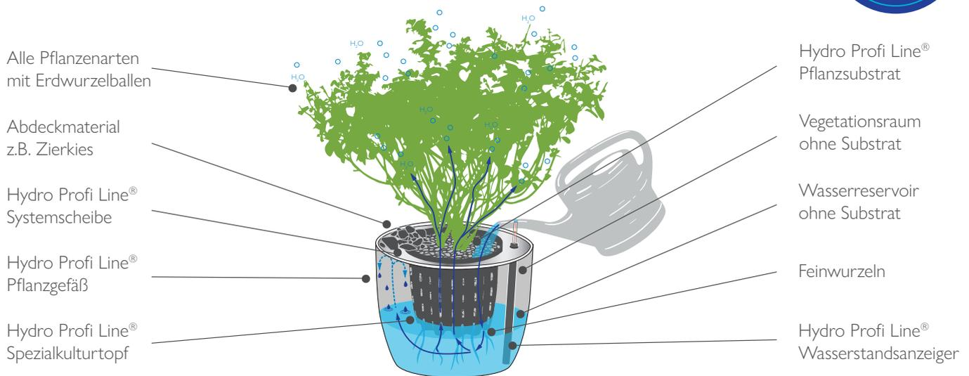
Im Hydro Profi Line® System werden Pflanzen in Spezialkulturtopfen in ein Modul gehängt und hängen somit in einer einzigartigen Wurzelvegetationskammer.
