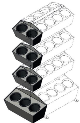
Modulgrößen: Länge 1.000 mm Breite 1.000 mm Höhe 2.500 mm
