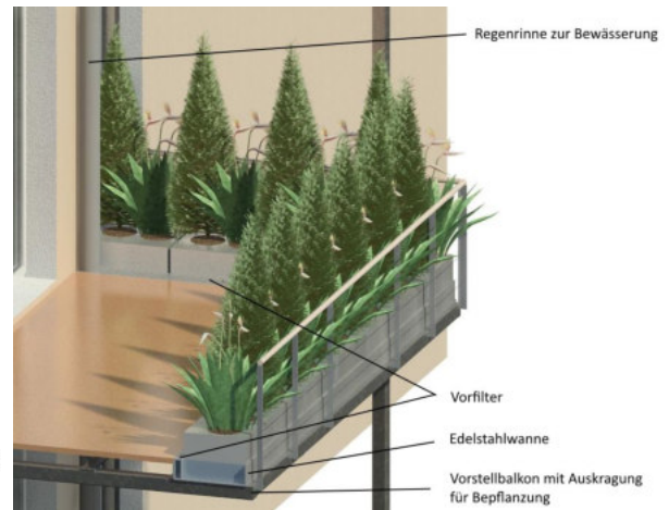
Abb. 3: Balkon Neubau/Dielenboden – Bodenmodule Installation des Wasserbeckens
